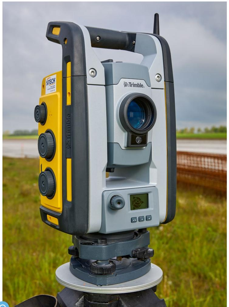
Die Tachymeter von Trimble können sich dank verschleißfreiem Magnetantrieb sehr schnell drehen.
